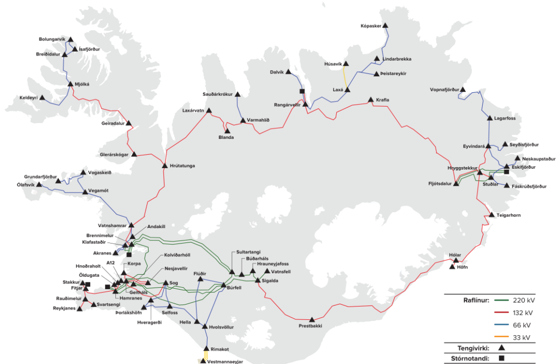
Mynd 12.3 Flutningskerfi raforku á Íslandi (Landsnet, 2016).
